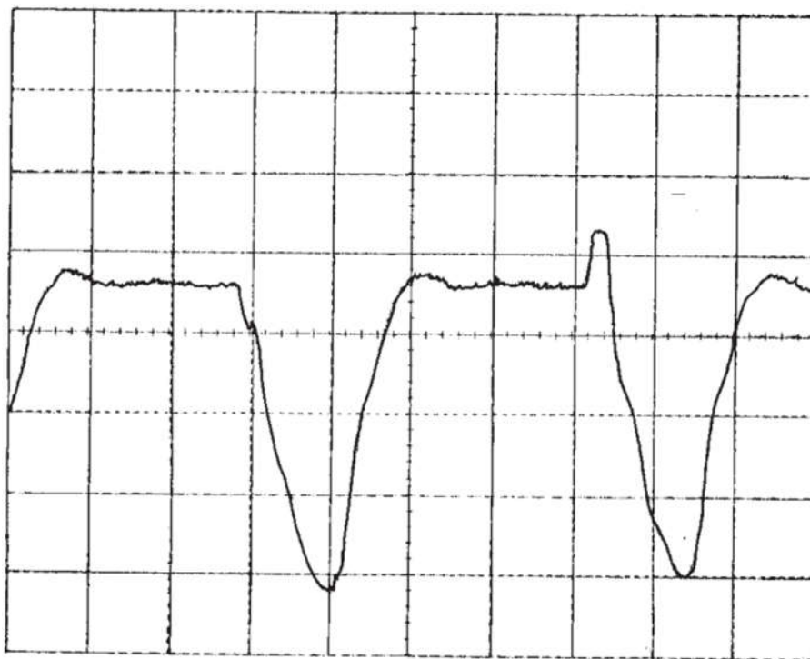
Nieszczelność na zaworze wydechowym
